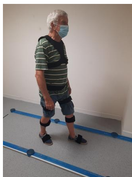
Figure 2: Participant équipé du système inertiel ISEN permettant la mesure de paramètres cinématiques de la marche et marchant entre les barres Optogait. L'Optogait récupère les paramètres spatio-temporels de la marche.
